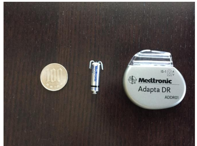
写真中央がリードレスペースメーカー 右が従来の植え込み型ペースメーカー
